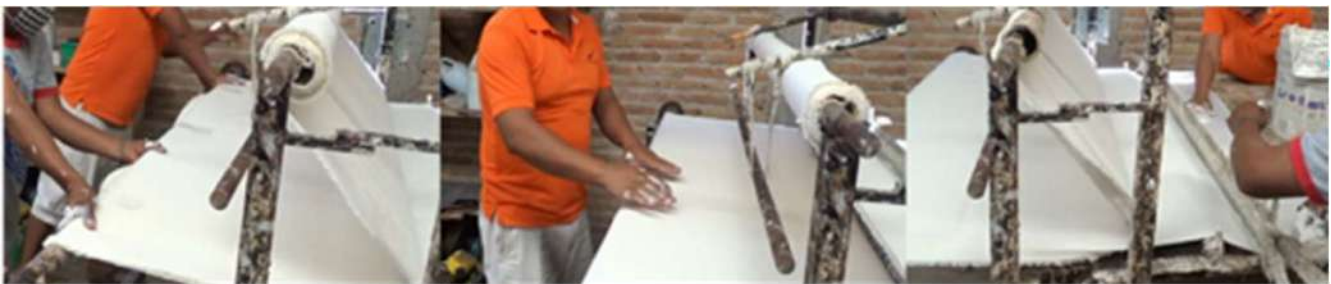
Proceso de pegado del vinil con lona
