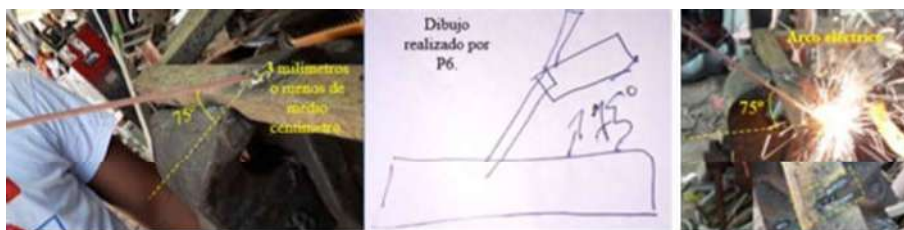
Figura 16a. Distancia entre el electrodo y la pieza: 3mm o menos de medio centímetro.
